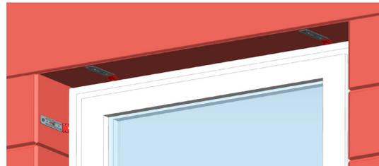
**Hinweis:** Anzahl der THERMINATOR richtet sich nach der Fenstergröße - Abstand zwischen den THERMINATOR darf bei Kunststofffenster max. 700 mm betragen. Das Gewicht des Fensters muss durch Trag- und Distanzklötze (nicht im Lieferumfang enthalten) an der Fenster-Unterseite aufgenommen werden
