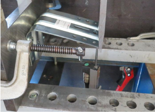
Bilder 4 – 5 Versagensbilder beispielhaft an Probekörper 05
