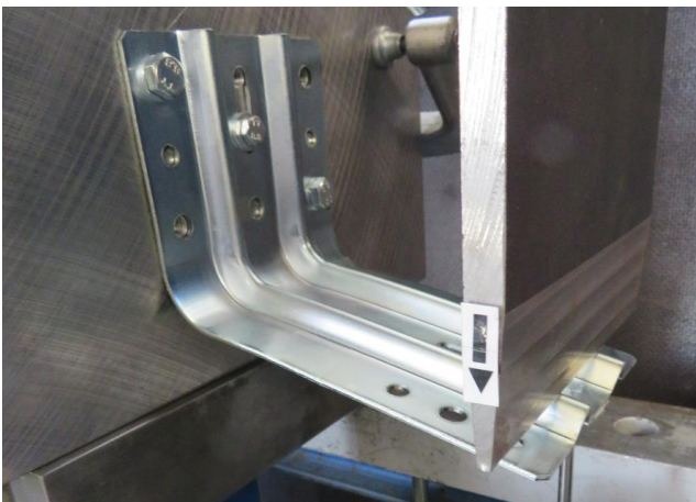
Bilder 6 – 7 Versagensbilder beispielhaft an Probekörper 01
